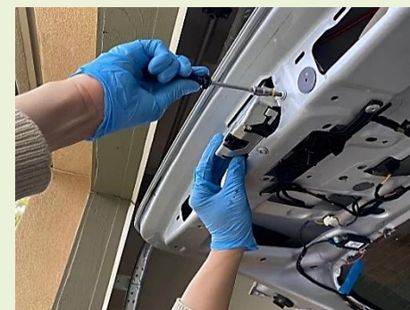
圖6) 擰下後門鎖上(tailgate latch)的三顆螺絲。
