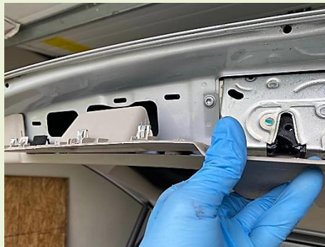
圖2) 用同樣的方法拆下最下端邊緣的那塊板，這張圖比較清楚的看到這些有彈性的金屬片(clip)。
