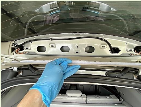
圖1) 拉開最上端的塑料板、注意內側有幾個金屬彈片卡在金屬孔上，開始的時候我一直不敢拉這塊板、就怕拉壞拉斷，其實工程師們在設計車的時候早就考慮到這種因素、我是杞人憂天了。
