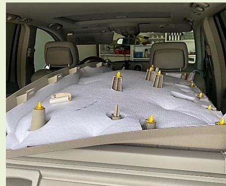
圖5) 拆下最大片也就不在話下了，但是這一片上面有很多黃色塑膠有膨脹性的(snap)要用不輕不重的力量把它拉下來、著力點要正確但不要害怕。
