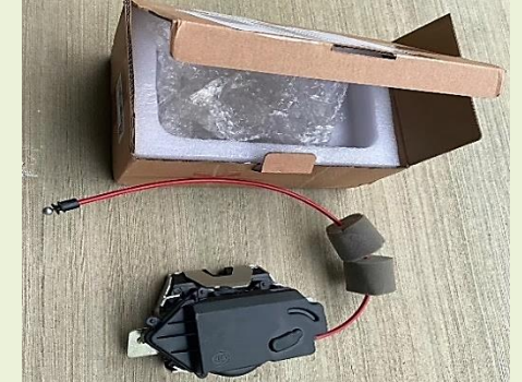
圖8) 將新零件裝回去並連結紅色的緊急後門開啟線。在測試功能完好之後將每一片板按照倒過來的程序一一裝回去就大功告成了。
