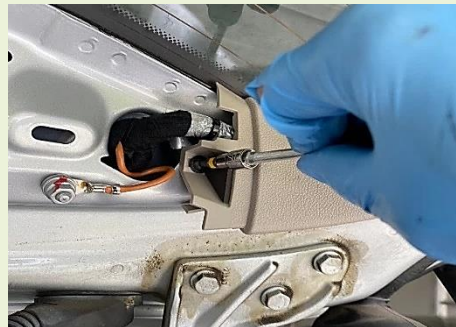
圖3) 拆下左右兩邊的板，各有一枚螺絲，整個的五大片裝飾板只有兩顆螺絲。
