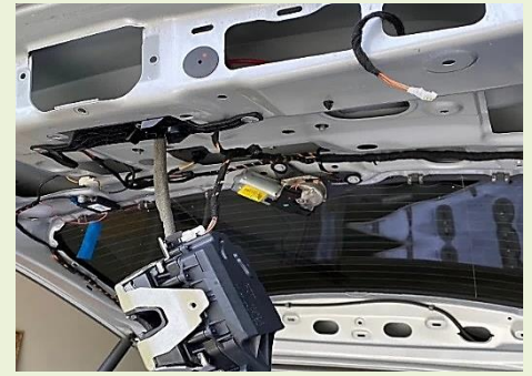
圖7) 移出門鎖、拔下電源。
